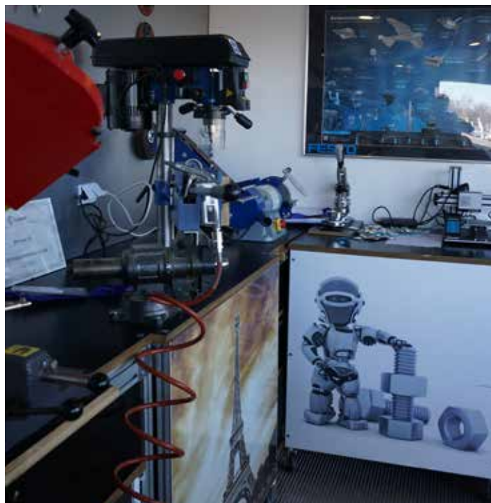
Metallitöökoda koos tarvilike tööriistadega, näiteks on seal metallisaag, puurpink, CNC-pink, sikemasin, jpm erinevaid elektrilisi tööriistu.
