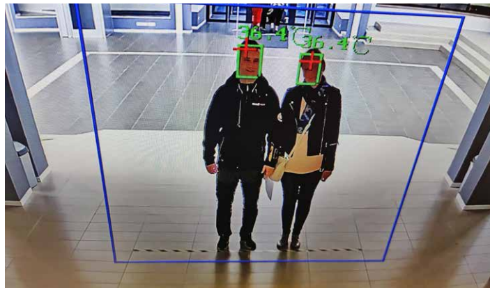
Termokaamera suudab korraga mõõta ka mitut inimest.
